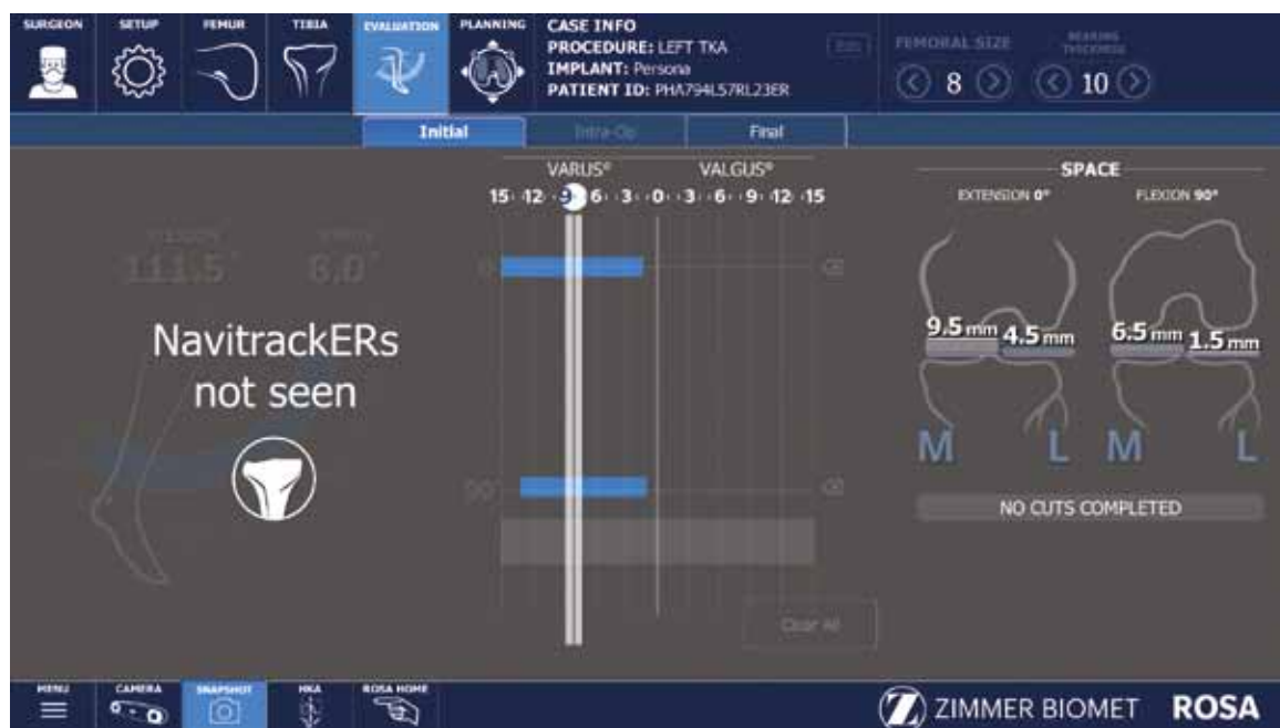
Obr. 2. Obrazovka s počátečním měřením kloubu – rozsah pohybu a laxita při varus a valgus stress testu (foto autora).
