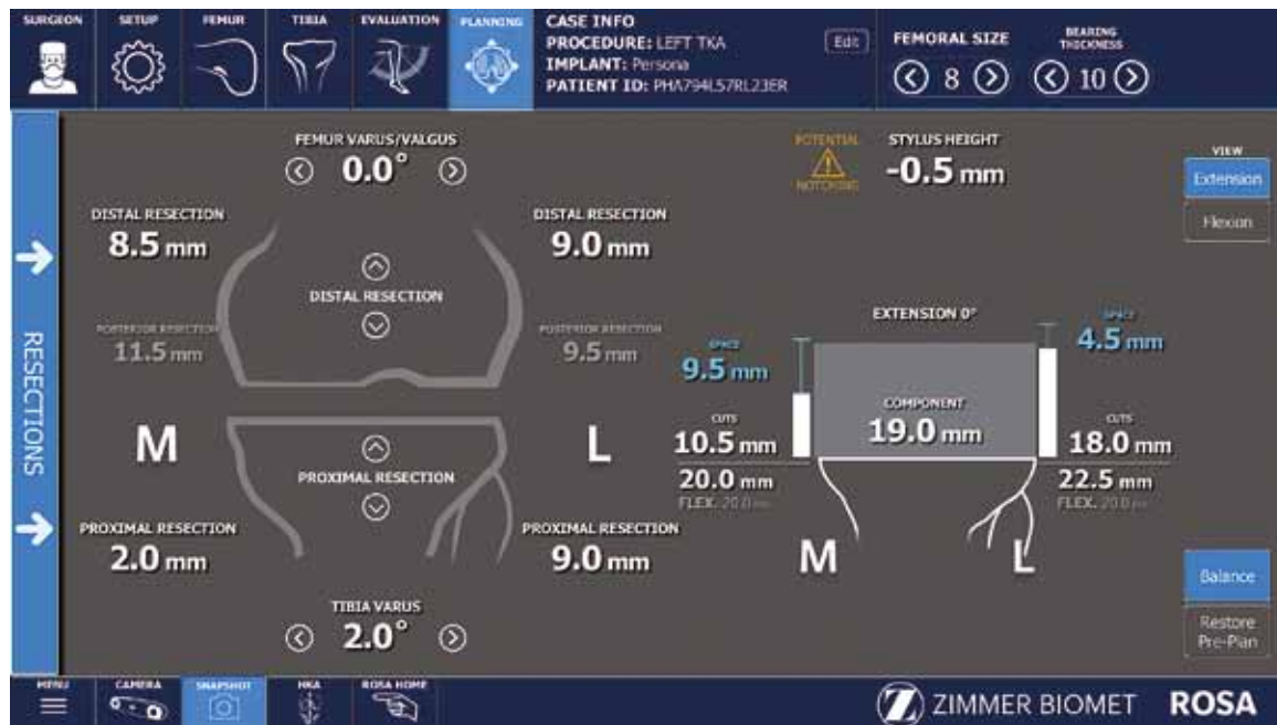
Obr. 1. Obrazovka s nastavením jednotlivých řezů při plánování (foto autora).
